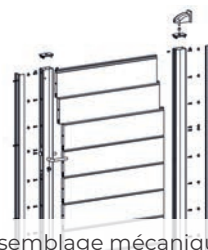
Système d'assemblage mécanique par Alvéovis
